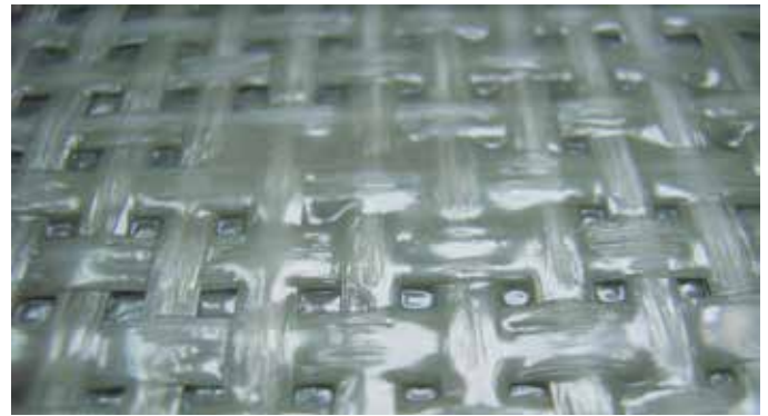
Fig. 7 – Nærbillede af en meget glat bagsidebelægning. I dette tilfælde skal lægningsmørtlen modificeres med kunststoffdispersionen PCI Lastoflex®.
