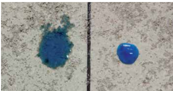
Fig. 6 – Til venstre PCI Gisogrund®, til højre PCI Gisogrund® Rapid. På begge grunder er der efter ca. 10 minutter anbragt en blå indfarvet vanddråbe. Den forventet tørre standardgrunder bliver fortyndet igen, mens PCI Gisogrund® Rapid allerede har dannet hinde.
